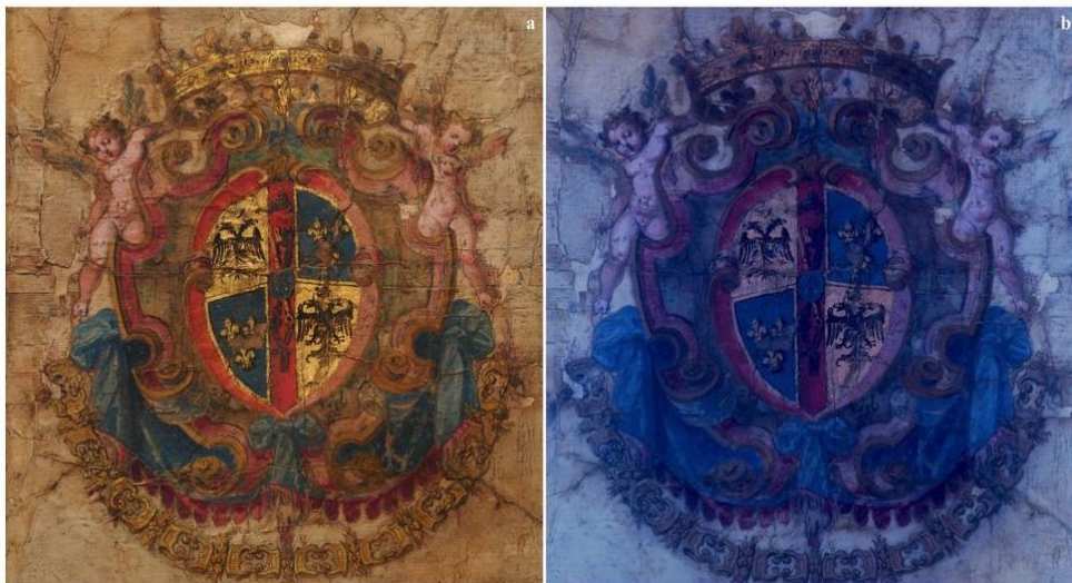
Fig. 11. Mappa raffigurante il territorio di Finale Emilia: a) immagine in luce visibile, particolare dello scudo araldico della Casa d'Este; b) immagine della fluorescenza indotta da luce ultravioletta. Il tono vinaccia che assume il rosso sotto irraggiamento UV è la tipica risposta del cinabro alla fluorescenza ultravioletta.
