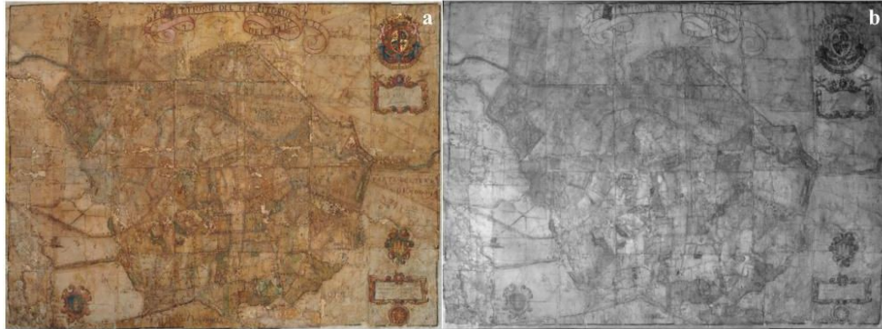
Fig. 18. Mappa raffigurante il territorio di Finale Emilia: a) immagine in luce visibile; b) riflettografia infrarossa a 1200nm, composizione di 350 riflettogrammi.
